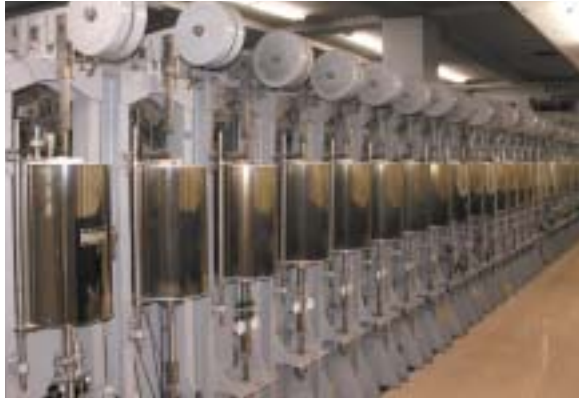
目黒地区 クリープ棟の単式クリープ試験機
