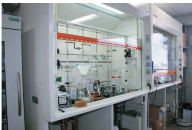
化学実験室のドラフトチャンバー(並木)
