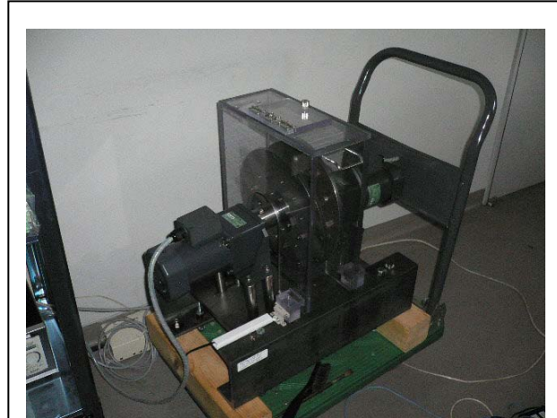
図1 小型電子機器破解機 (サイズ感がわかるように台車に乗せて撮影)
