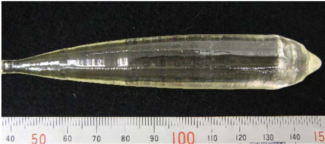
図1 磁性ガーネット TSLAG 単結晶 (直径約1インチ)
