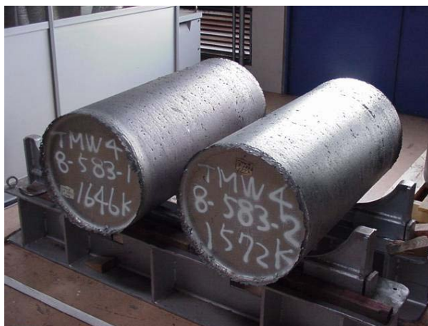
図 インゴットの例 (三菱マテリア作成/写真は 1.6ton の VAR インゴット)
