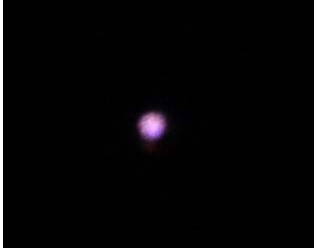
図3 フッ化物強誘電体BaMgF 4 単結晶によるQPMデバイスから得られたSHG紫色発光 (波長 406nm)
