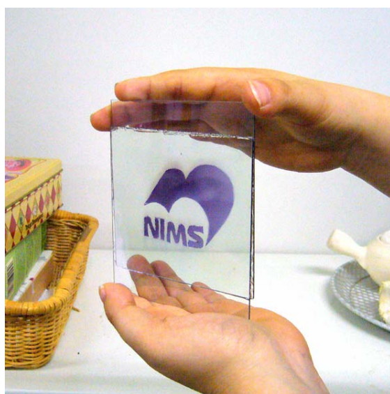
図1 薄さ2mmのエレクトロクロミックデバイス
