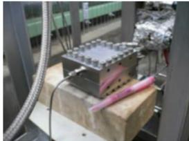
図 36cmのV合金膜を組み込んだ水素透過モジュールの外観
