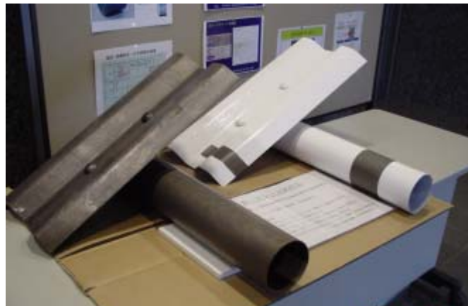
高リン含有鋼により作製したガードレール
