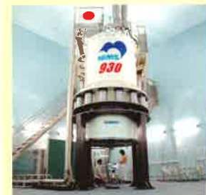
世界最高磁場の固体NMR磁石
