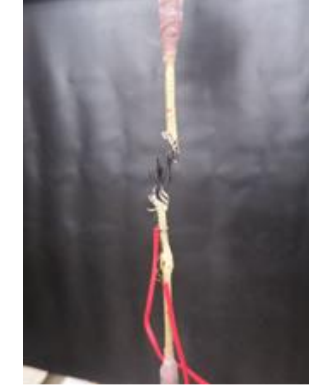
破断試験片外観 試験片中央部で破断
